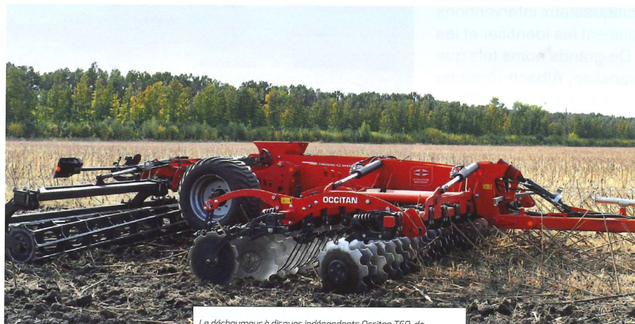
Le déchaumeur à disques indépendants Occitan T60, de Grégoire Besson, peut travailler jusqu'à 18 cm de profondeur.
