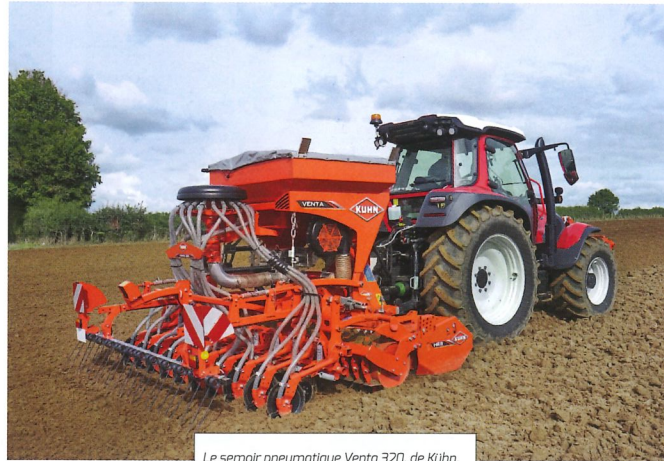
Le semoir pneumatique Venta 320, de Kühn, avec éléments semeurs monodisque.
