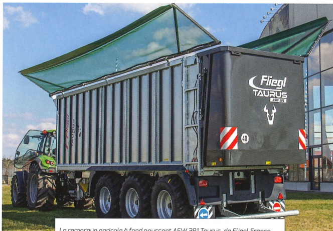
La remorque agricole à fond poussant A5W 391 Taurus, de Fliegl France, dispose d'un volume de 50 m 3 pour un PTAC de 31 tonnes.
