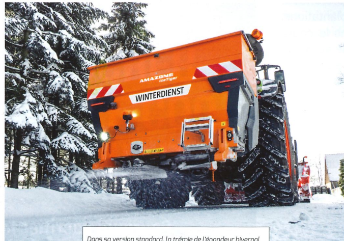
Dans sa version standard, la trémie de l'épandeur hivernal Amazone IceTiger possède une capacité de 1 000 litres.
