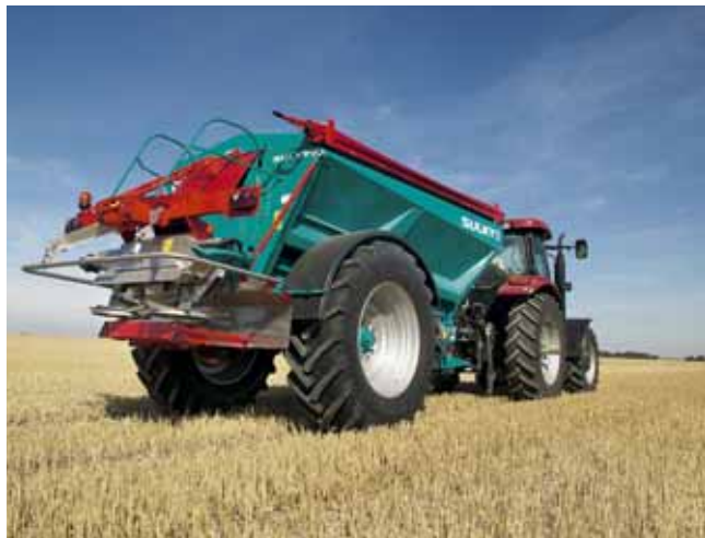
Une rampe à vis de 9 mètres permet au Polyvrac XT 130 d'épandre des produits pulvérulents.
