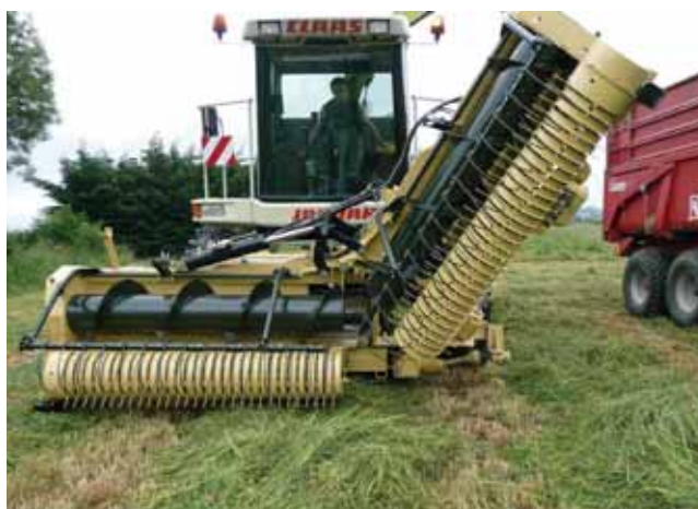
Plus besoin de descendre de son ensileuse pour réduire la taille de sa tête de récolte !
